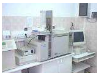
Na fotografii: Chromatograf sprzężony z detektorem mas (GC/MS) w Laboratorium Badań Materiałów i Opakowań Jednostkowych
